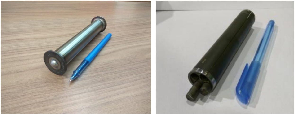
Рисунок 4.3 - Контейнер с образцами перед помещением в камеру для горячего изостатического прессования (а) и вид сваренной заготовки с вырезанными из нее образцами для испытаний (б)
